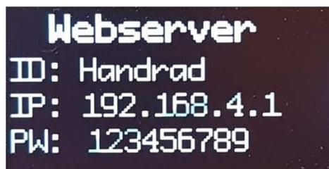
Nachdem der eingebaute WLAN Hotspot aktiviert wird, können Sie sich entweder mit dem Handy, Tablet oder dem PC verbinden.
