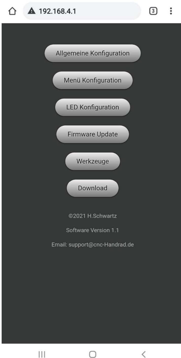
Durch Anklicken einer Rubrik wird man auf die dementsprechende Konfigurationsseite weitergeleitet.
