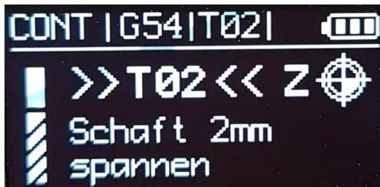
Zeigt die Platznummer vom zu wechselnden Werkzeug an sowie im Klartext das einzusetzende Werkzeug.
